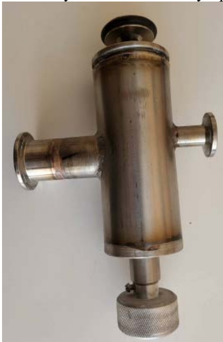
Рис.4б. Устройство для контроля и откачки вакуума в криососудах с вакуумной пробкой.
