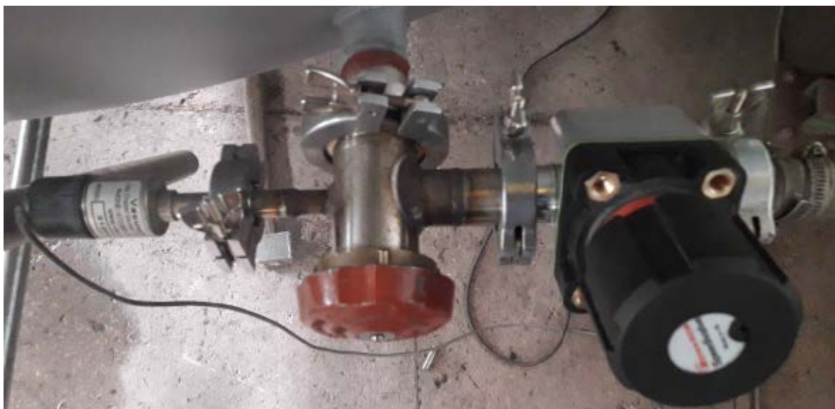
Рис 4в. Узел замера и откачки вакуума в сборе на вакуумной пробке сосуда криогенного. Устройство в состав поставки не входит и заказывается отдельно.
